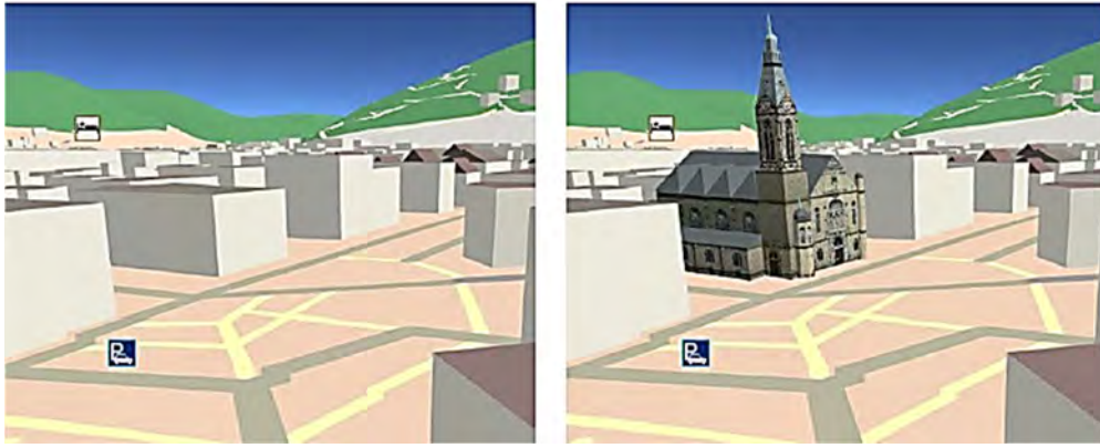
شکل ۵- جانپهان مدل‌های سه‌بعدی ساختمانی کامل در OSM-3D. در شکل سمت راست یک مدل ساختمانی کامل به صورت دستی در جای خود قرار گرفته و با مدل‌های پارامتریک در یک نمایش یکپارچه شده است. [۱۱]
